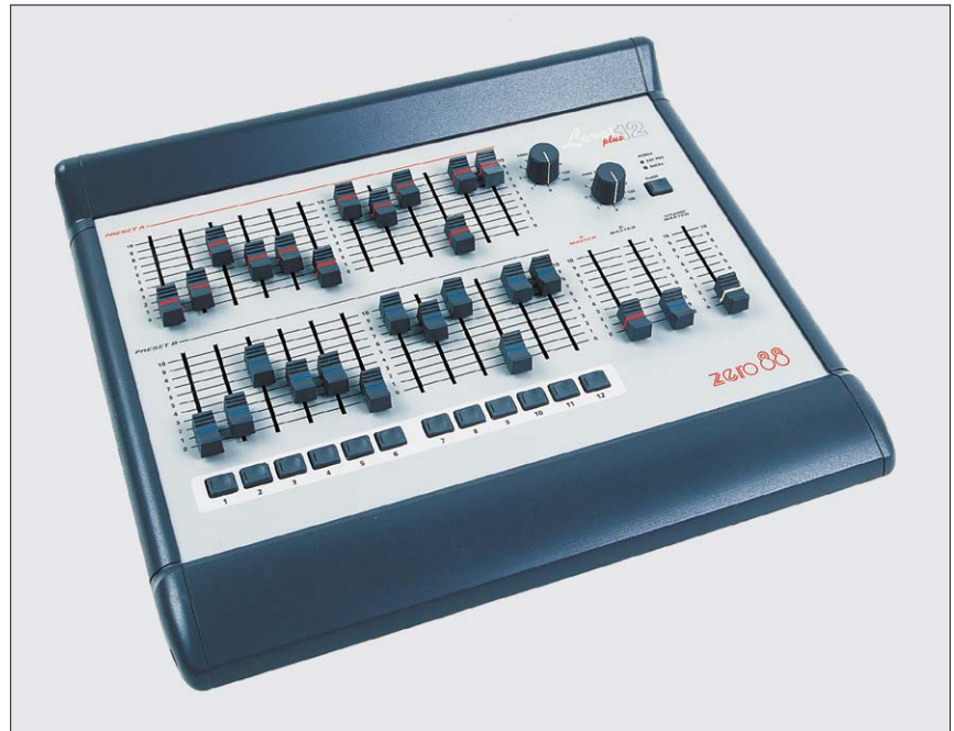
Analoges Pult 12 Kreise. Bestellnummern: STP10012 (12 Kreise) STP20024 (24 Kreise)
